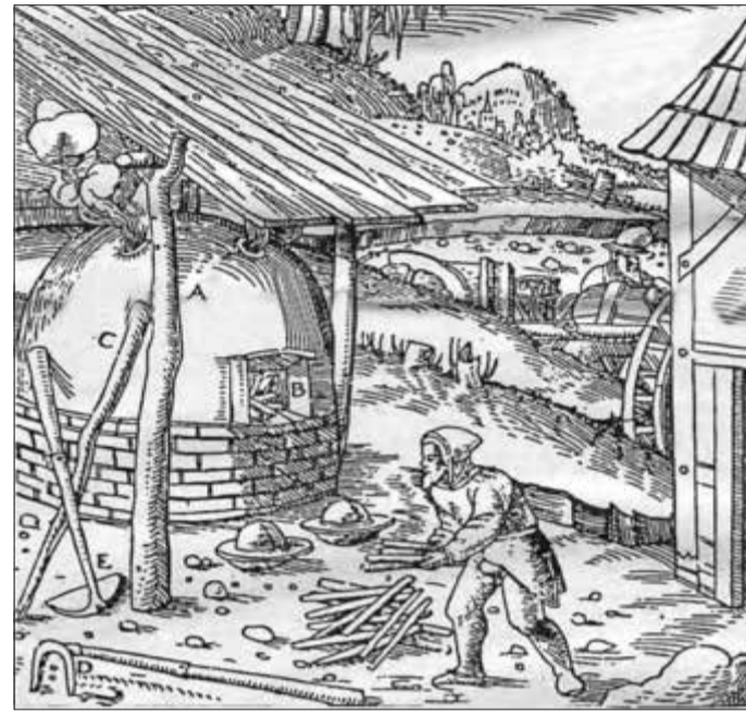
Hochofen im Mittelalter; nachweisbar in der hier gezeigten Bauart ist der Hochofen zu Beginn des 14. Jahrhunderts. Die damaligen Öfen im Hunsrück waren etwa 4 bis 7 m hoch, ihre Haltbarkeit war sehr gering (15-45 Betriebs-tage).
